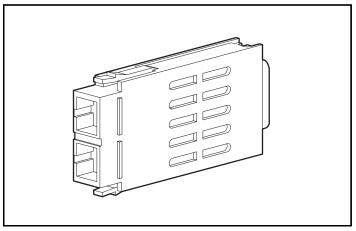
Figure 2-2. GigaBit Interface Converter (GBIC) module
